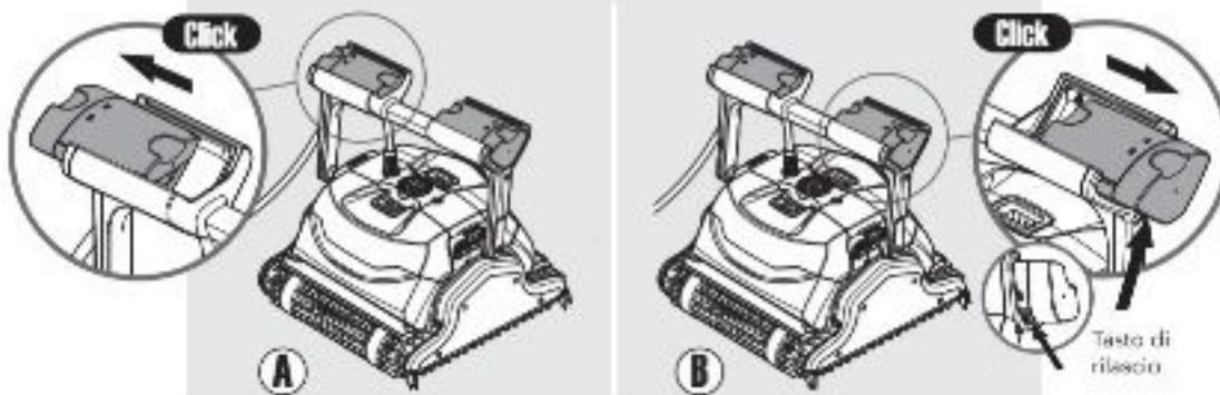
Per spostare i galleggianti di nuovo nella loro posizione originale: premendo il tasto di rilascio alla base del galleggiante del manico – spingi indietro il galleggiante del manico.
