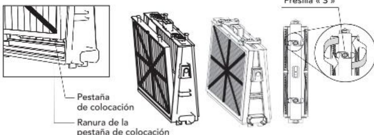
Reinstale los bastidores de base con filtros según la ilustración.
