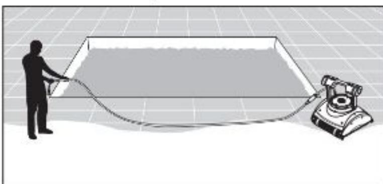
Wickeln Sie das Kabel ab und ziehen Sie es vollständig aus, so dass es nicht geknickt wird.
