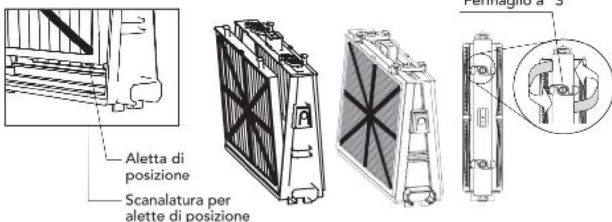
Re-istallare i telai di base con i filtri secondo il diagramma.
