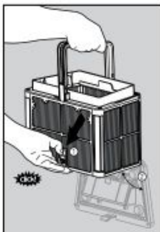
6.1.4 Den Riegel öffnen, um den unteren Deckel freizugeben und eventuelle Verunreinigungen zu entfernen.
