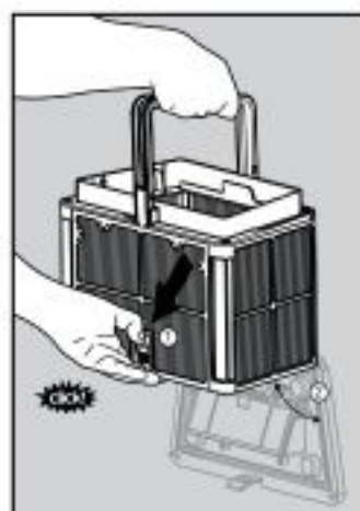
6.1.4 Abra el cierre para liberar la tapa inferior y poder eliminar las impurezas.
