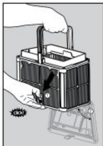
6.1.4 Om het vuil te verwijderen, druk de vergrendeling omlaag voor het openen van de bodem.
