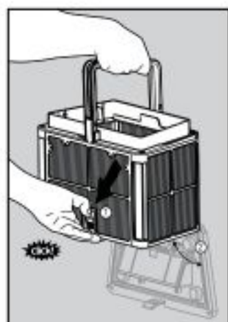
6.1.4 Ouvrez le loquet pour relâcher le panneau du bas et extraire les déchets.
