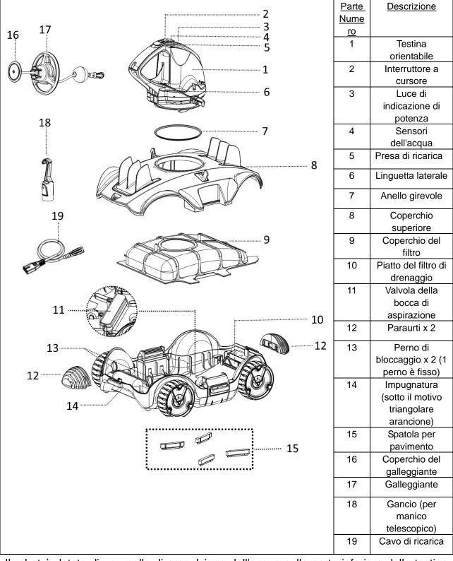
Il robot è dotato di un ugello di propulsione dell'acqua sulla parte inferiore della testina girevole. L'acqua viene prima aspirata verso l'interno dalla bocca di aspirazione collocata sulla parte inferiore del robot, passa attraverso il filtro e viene quindi scaricata dall'ugello
