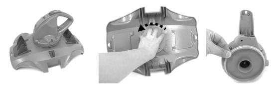
2. Usare il cacciavite per svitare le 4 viti collocate nella parte inferiore della testina per rilasciare il piatto inferiore. Usare il cacciavite per svitare tutte le viti presenti sulla base, come illustrato. Rimuovere la ventola e sollevare la base e rimuoverla per esporre la testina all'interno.
