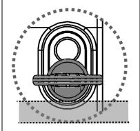
Se la traiettoria del robot è troppo curva, estrarre il perno e inserirlo in questo foro. Accertarsi che l'asse della ruota sia stato collocato sotto.
