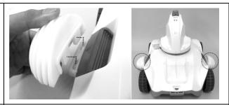
Se il robot tende a fermarsi più a lungo in alcune zone di una piscina quadrata o rettangolare stretta, collocare un paraurti sulla parte frontale e posteriore del robot per eliminare questo schema.
